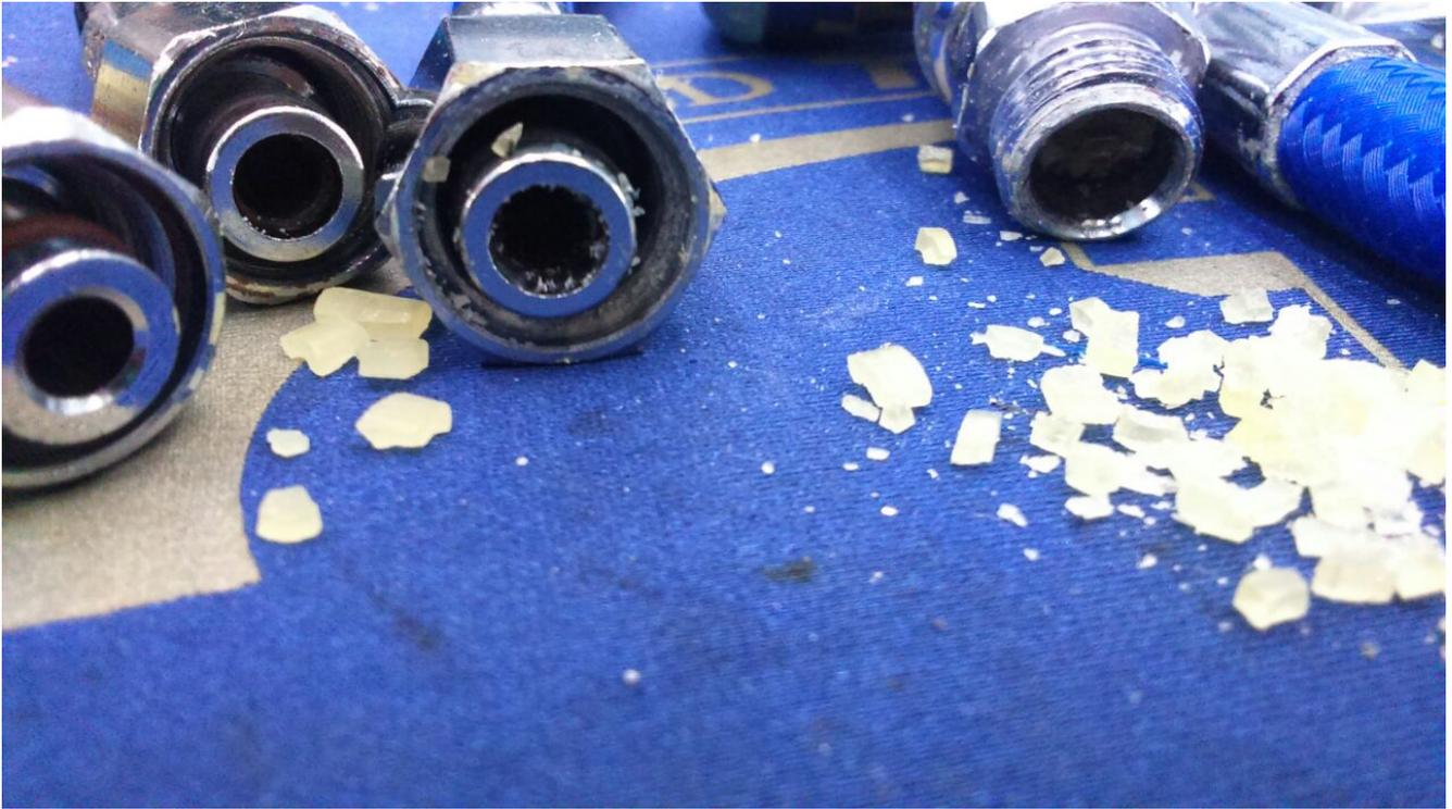
Es ist schwer vorherzusagen, wie lange der Zerfall einer Innenbeschichtung aus Polyester-TPU dauert, aber die uns vorliegenden Informationen lassen vermuten, dass dies bei freiliegenden Schläuchen bei 30°C und hoher Luftfeuchtigkeit in relativ kurzer Zeit der Fall sein kann.
