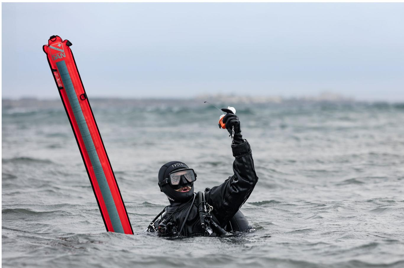
L'*Ocean Signal RescueME PLB1* et l'*ARC ResQLink View* sont deux appareils de classe *PLB*, qui signifie « *Personal Locator Beacon* » (*balise de localisation personnelle*). Contrairement au *Nautilus*, qui s'appuie sur l'*AIS* et la radio marine, les *PLB* contactent un réseau de satellites pour déclencher une alerte *SOS* mondiale.
