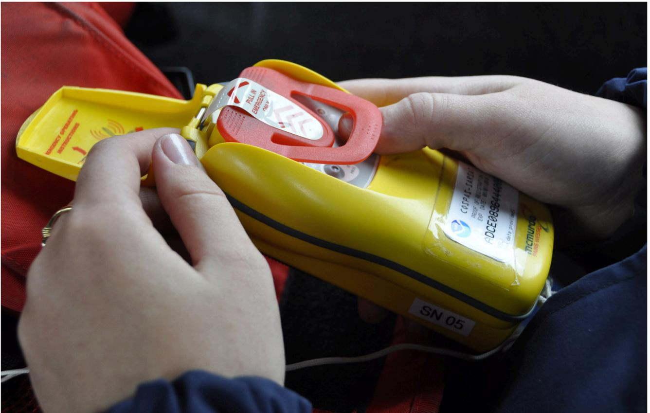
Un **PLB** è un localizzatore personale satellitare che permette ai servizi SAR di localizzare una persona sia sulla terraferma che in mare. Quando è attivato, il PLB trasmette un messaggio codificato sulla frequenza di emergenza 406 MHz, che è monitorata dalla rete satellitare COSPAS-SARSAT<sup>2</sup>. Il messaggio è poi inoltrato tramite una stazione terrestre di comunicazione via satellite al più vicino centro di coordinamento del soccorso, che attiverà i servizi SAR del luogo.
