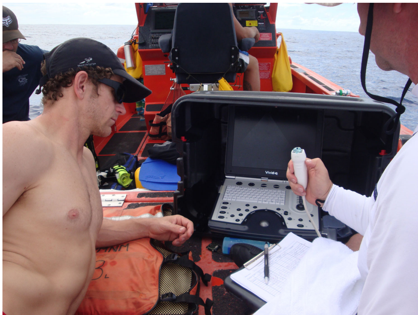
Neal Pollock przeprowadzający echokardiografię przezklatkową (TTE) u nurka po nurkowaniu głębokim. Obecność pęcherzyków we wszystkich czterech jamach serca jest oceniana w spoczynku i po wykonaniu ruchów kończyną po poleceniu przez badacza.
